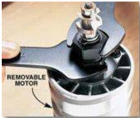
Gambar 17.10. Ilustrasi Pelepasan Pisau Router (Sumber: Kuncoro, 2013)
