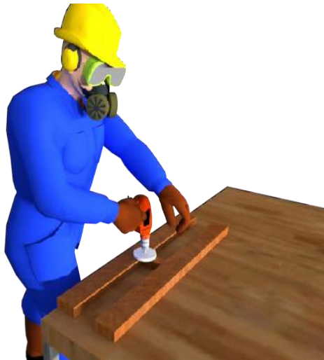
Gambar 16.18. Ilustrasi Menggerinda dengan Mesin Bor
