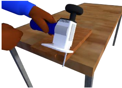
Gambar 13.10. Ilustrasi Menggergaji Miring dengan Mesin Jigsaw
