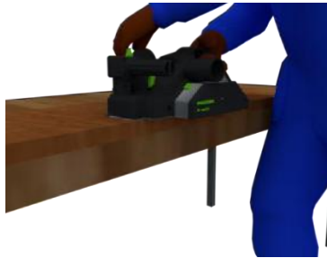
Gambar 14.9. Ilustrasi Pengetaman Permukaan Kayu
