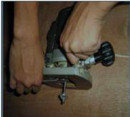
Gambar 17.9. Ilustrasi Pemasangan Pisau Router (Sumber: Kuncoro, 2013)
