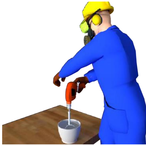
Gambar 16.15. Ilustrasi Pengadukan Bahan dengan Mesin Bor
