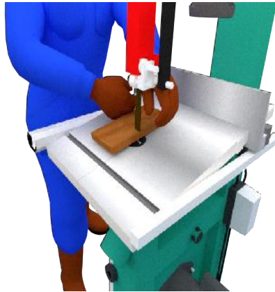
Gambar 8.4. Ilustrasi Pembuatan Bevel atau Chamfer dengan Gergaji Pita
