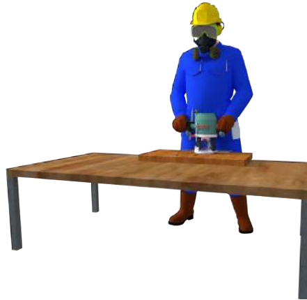
Gambar 17.25. Ilustrasi Penggunaan Mesin Router
