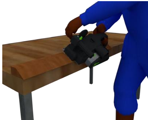
Gambar 14.11. Ilustrasi Pengetaman Miring
