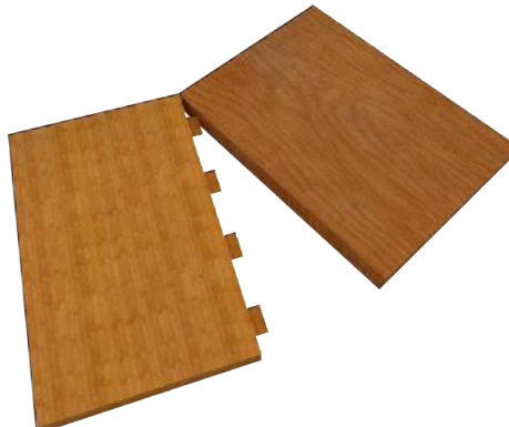
Gambar 18.14. Ilustrasi Penyusunan Sambungan Pelebaran Papan
