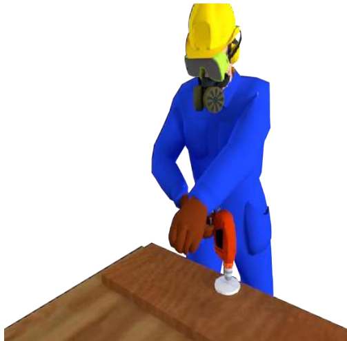
Gambar 16.17. Ilustrasi Proses Pengupam dengan Mesin Bor
