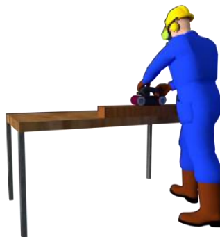
Gambar 15.13. Ilustrasi Penggunaan Mesin Ampelas Portable
