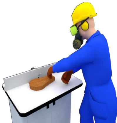
Gambar 9.4. Ilustrasi Pembuatan Profil pada Kayu Lengkung dengan Mesin Shaper
