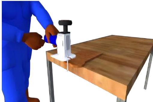
Gambar 13.12. Ilustrasi Penggergajian Lengkung dengan Mesin Jigsaw
