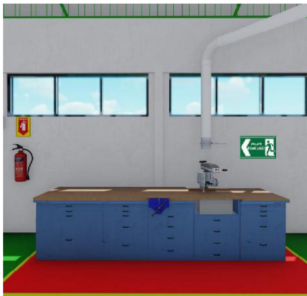
Gambar 19.7. Ilustrasi Penempatan Rambu Penanda Jalur Evakuasi dan Penempatan Rambu Penanda APAR
