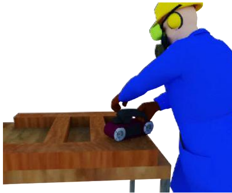
Gambar 15.7. Ilustrasi Pengampelasan Kerangka Kayu
