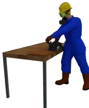
Gambar 14.14. Ilustrasi Penggunaan Mesin Ketam Portable
