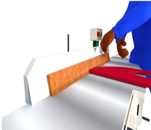
Gambar 5.4. Ilustrasi Pengetaman Bevel atau Chamfer
