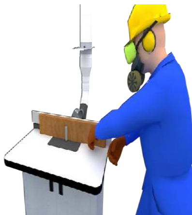
Gambar 9.3. Ilustrasi Pembuatan Alur dengan Mesin Shaper
