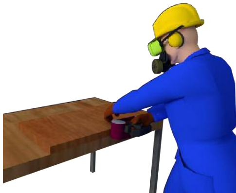
Gambar 15.8. Ilustrasi Pengampelasan Sisi Tebal Kayu
