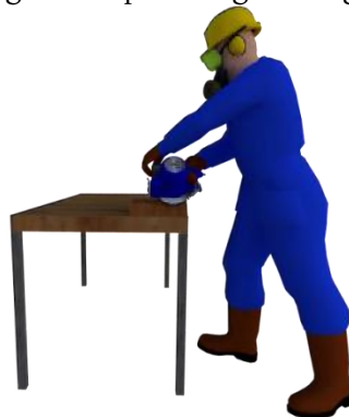
Gambar 12.15. Ilustrasi Penggunaan Mesin Gergaji Tangan Listrik
