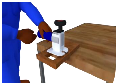
Gambar 13.9. Ilustrasi Pembuatan Lubang dengan Mesin Jigsaw
