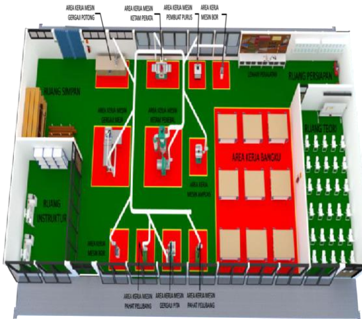
Gambar 2.3. Ilustrasi 3D Layout Bengkel Kerja Kayu
