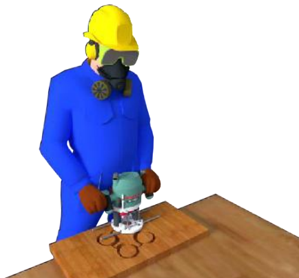
Gambar 17.23. Ilustrasi Pembuatan Alur Hias dengan Alat Jangka
