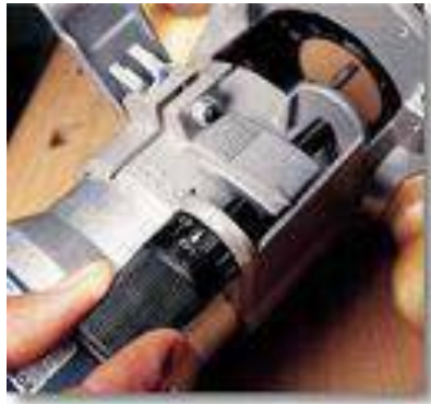
Gambar 17.11. Ilustrasi Pengaturan Kedalaman Pisau Router (Sumber: Kuncoro, 2013)
