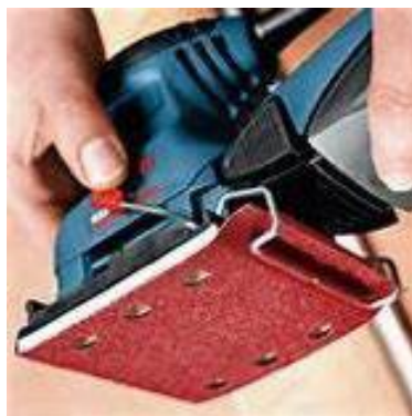
Gambar 15.10. Ilustrasi Pemasangan Kertas Ampelas (Sumber: Kuncoro, 2013)
