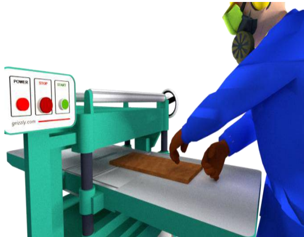
Gambar 6.3. Ilustrasi Pengetaman Papan Kayu Tipis
