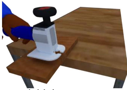
Gambar 13.8. Ilustrasi Membelah dan Memotong Lurus dengan Mesin Jigsaw
