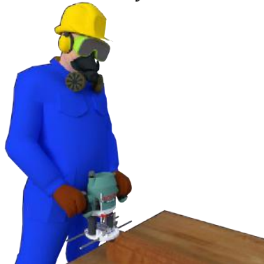
Gambar 17.13. Ilustrasi Pembuatan Sponing dengan Mesin Router
