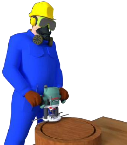
Gambar 17.14. Ilustrasi Pembuatan Alur Lengkung dengan Mesin Router
