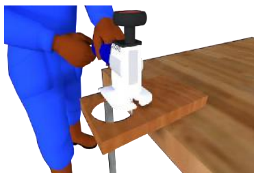
Gambar 13.11. Ilustrasi Pembuatan Lingkaran dengan Mesin Jigsaw
